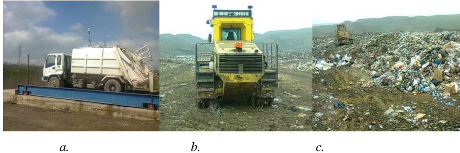
Figura 5. a .Peshorja para hyrjes në deponi; b.Tipi i kompaktorit “Bomag”, për kompaktim mbeturinash; c.Pjesë e deponisë para trajtimit -Mirash
