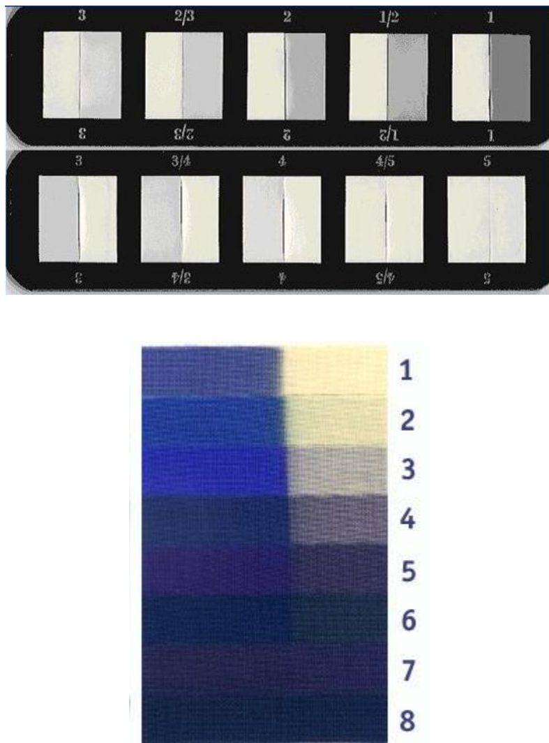
Figura 2. Shkalla gri dhe blu e leshit për testimin e qëndrueshmërisë së ngjyrës
