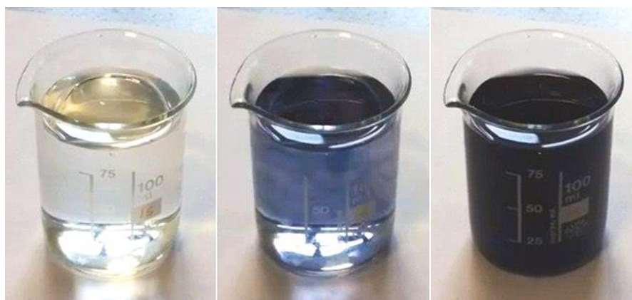
Figura 3. Vlerësimi i shpejtësisë të reaksioneve kimikë në prani të katalizatorëve mund të realizohet nga eksperimenti i acidit askorbik dhe peroksidit të hidrogjenit (katalizatori)
