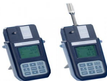
Figura 1. Pajisja “Monitori i CO 2 , DeltaOhm HD21AB17”, e përdorur për matjen e nivelit të CO 2 dhe lagështirës ajrore
