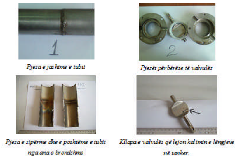
Figura 2. Pamje nga sipërfaqja e brendshme e tubave dhe kllapës së korroduar
