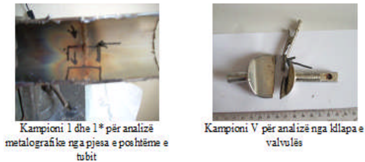
Figura 3.- Marrja e kampioneve për analizë metalografike.
