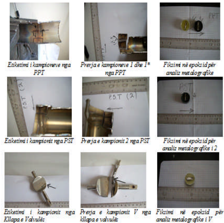
Figura 4.- Mostrat me epoksid të marrë nga prerja tërthore e tubave
