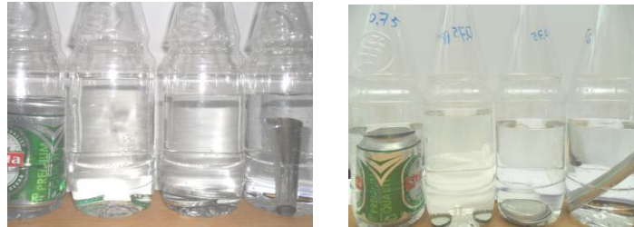
Figura1: Pamje para dhe pas 3 ditësh së pajisjeve në tretësirë 2 mg/l \text{ClO}_2
