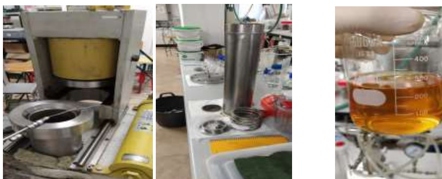
Figura 2. A- Ena ku vendoset ekstraktuesi dhe pompa e sigurisë, B- Ekstraktuesi, C- Vaji i tretur në acetone
